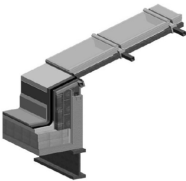
图 6 屋顶天窗细部节点 BIM 深化设计效果图 中德项目的天窗具有智能遮阳通风的功能,其中部设置中悬式开启窗,并辅助安装智能遮阳帘,以达到绿色建筑的设计要求,遮阳通风的 BIM 深化设计有效降低了建筑投入使用后空调等设备的使用频率。
